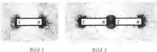
Bild 1 zeigt, wie sich die Eisenteilchen unter dem Einfluß eines Stabmagneten ordnen. Wir sehen Ketten von Eisenteilchen, die gewissermaßen an einem Ende des Stabes entspringen und am andern Ende dieses Stabes in ihn einmünden. Das ganze Bild läßt es verständlich erscheinen, daß man hier von zwei Polen des Stabmagneten spricht.
