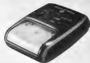
Außerdem lassen sich einfache überschlägige Kapazitätsmessungen in den Bereichen 0...25...250...2500 μF anstellen, wobei der entladene Prüfling mit Hilfe der eingebauten Batterie aufgeladen wird und der Ladestrom einen ballistischen Zeigerausschlag bewirkt. Das kleine Meßgerät kann mit einem Lederarmband am Handgelenk befestigt werden, so daß man beim Arbeiten an schwer zugänglichen Stellen beide Hände frei hat (Metrawatt AG, Nürnberg).
